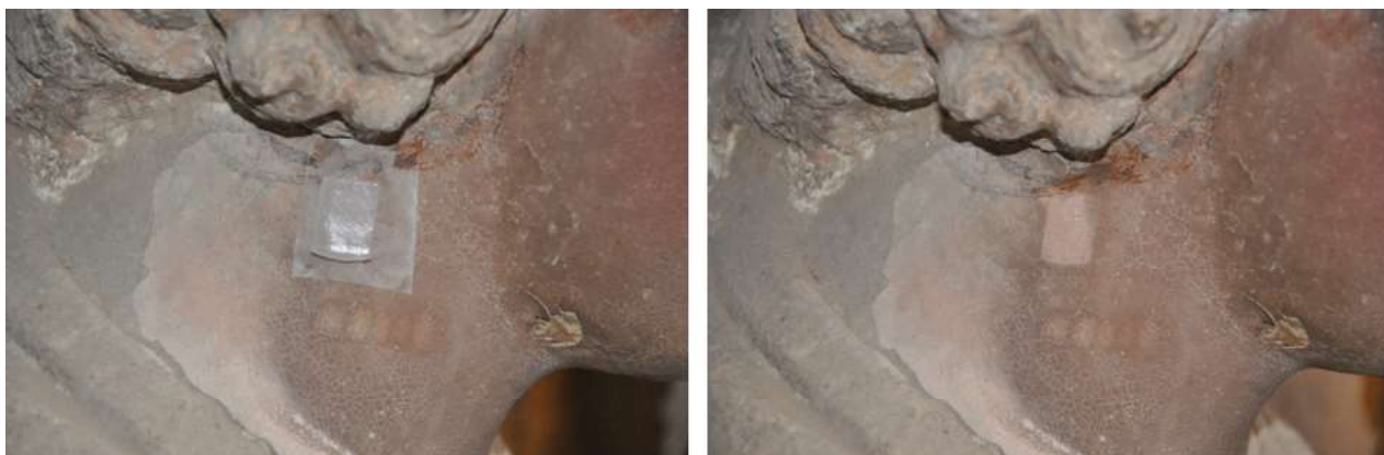
Figura 5. Aplicación del sistema de limpieza con hidrogel en el área de ensayo de una figura policromada del Pórtico de la Gloria.
