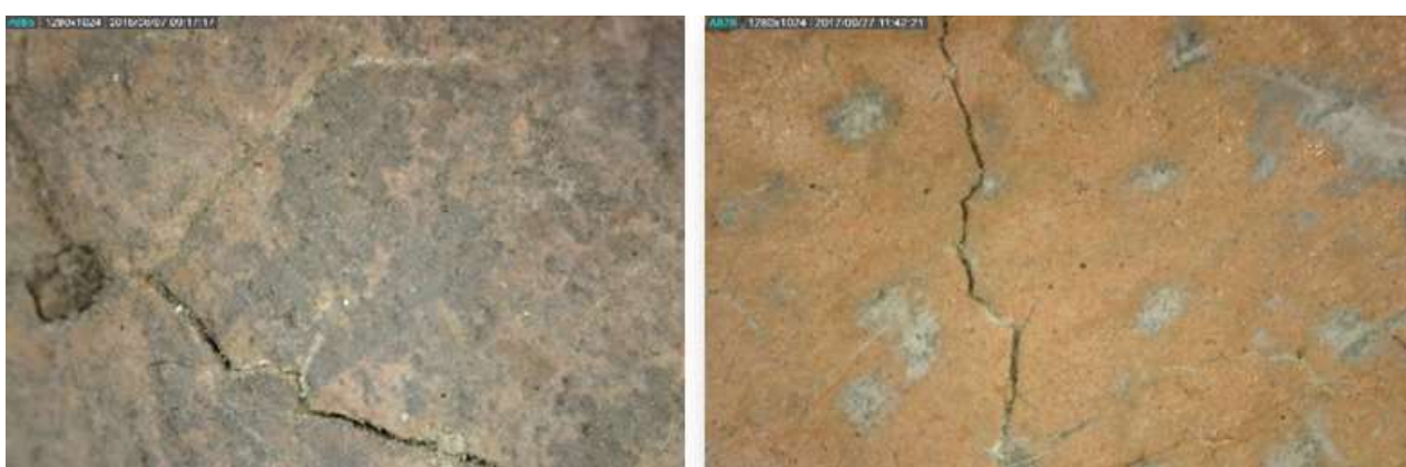
Figura 6. Ejemplo de documentación con video microscopio del área de ensayo de la policromía sobre piedra. a) Antes del tratamiento de limpieza. b) Después del tratamiento de limpieza.
